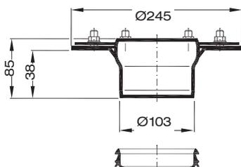
**Aufsatzelement mit Muffe**
